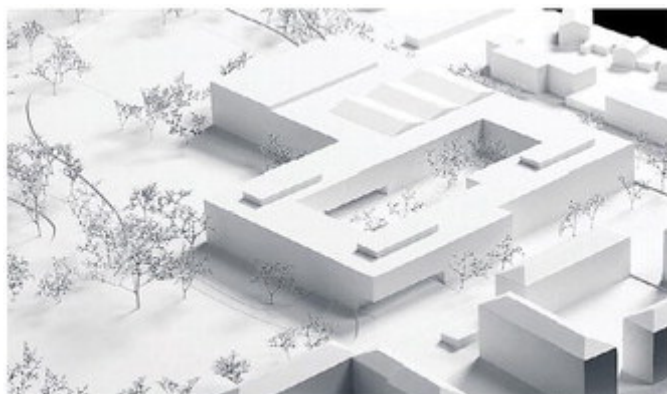
Das Gewinnerprojekt Pepiniere: Auf das bestehende U-förmige Gebäude der Berufsschule wird die Kantonsschule gebaut. Neu ist der Verbindungstrakt zur Turnhalle. Dies ergibt eine Rechteckform mit Innenhof.
